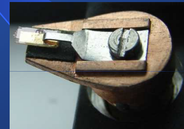
Widok belki pomiarowej (cantilevera)
