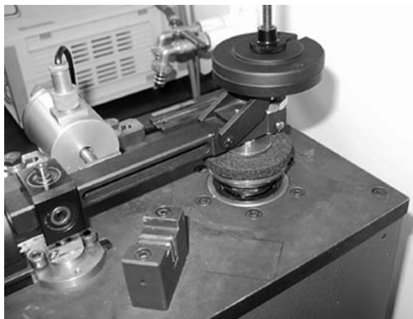
Rys. 1. Widok zmodyfikowanego testera T-01M, przystosowanego do badania zużycia ściernego metali [5]
