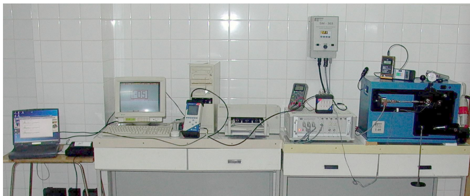
Rys. 1. Stanowisko badawcze tester T-05 z aparaturą pomiarową
