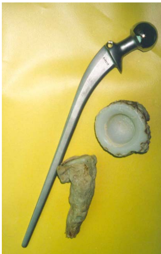
Rys. 1 b Usunięta endoproteza Wellera wraz z fragmentem cementu.
