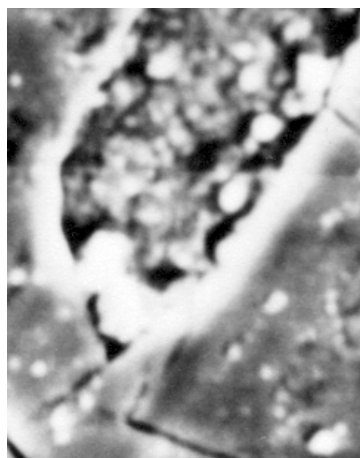
Rys. 3. Topografia powierzchni materiału Heliomolar przed – a, i po tarcii – b (x1000)
