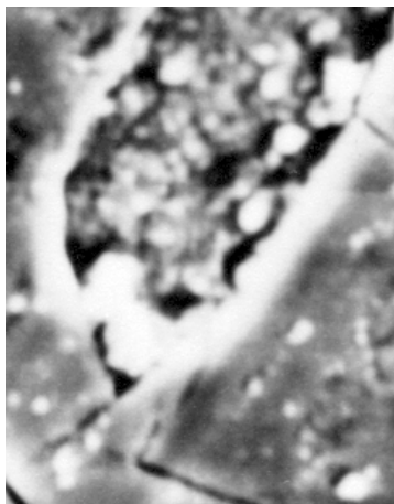
Rys. 3. Topografia powierzchni materiału Heliomolar przed – a, i po tarceniu – b (x1000)
