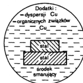
Rys. 8. Model systemu tribologicznego stal-stal-środek smarujący zawierający: -dyspersję miedzi lub jej stopu, -organiczne związki Cu
